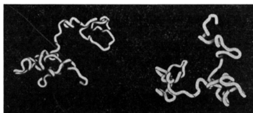
Fig. 5. Beispiel eines statistisch geknäuelten Fadenmoleküls, praktisch verwirklicht z. B. durch eine in Wasser gelöste Methylzellulose vom Polymerisationsgrad Z \approx 2500 .
